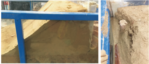
(a)加固后边坡整体变形情况 (b)开挖观察桩体
